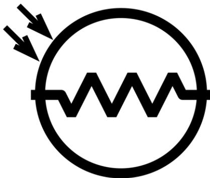
**FIG: CIRCUIT SYMBOL OF PHOTORESISTOR**
